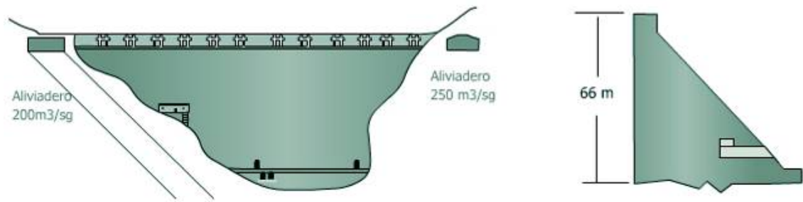
Figura 53. Presa del Embalse de Camporredondo. Alzado y Sección (Fuente: Confederación Hidrográfica del Duero).
